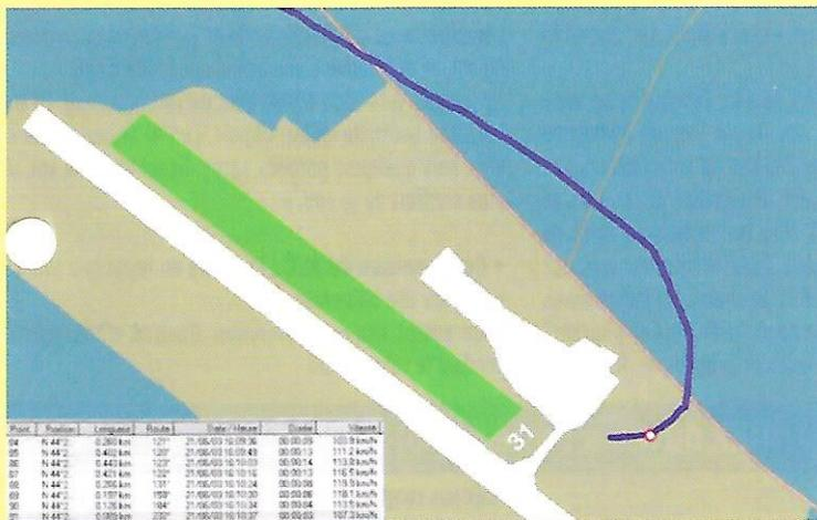
La trajectographie suivante est issue du récepteur GPS présent à bord. Les derniers points montrent l'avion en virage avec une inclinaison proche de 35 degrés et une vitesse propre calculée très proche de la vitesse de décrochage qui est de 75 km/h.
